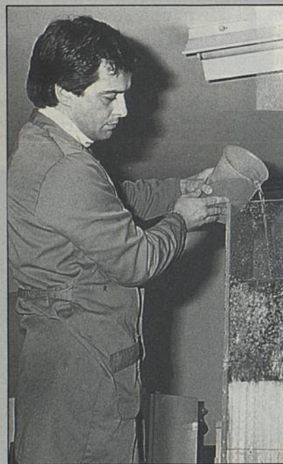
Les différentes couches d'un filtre à base de sable sont testées en labo.
