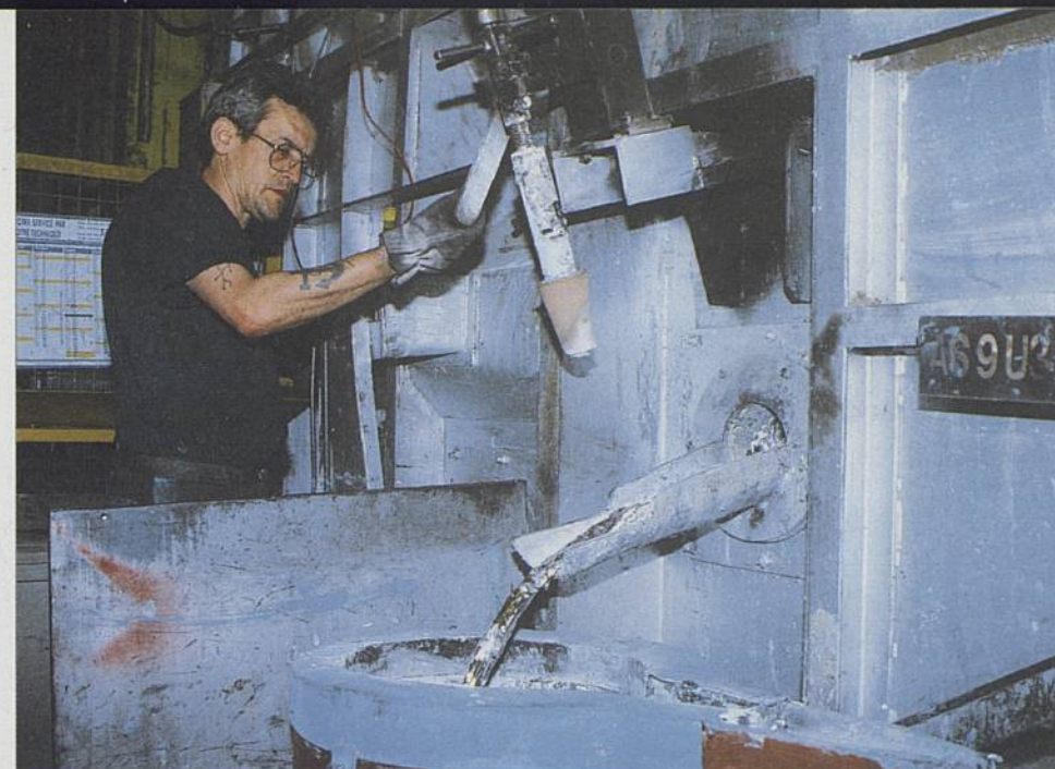
Désormais, le transfert de la plupart des matières en fusion se fera automatiquement et non plus à la louche.
