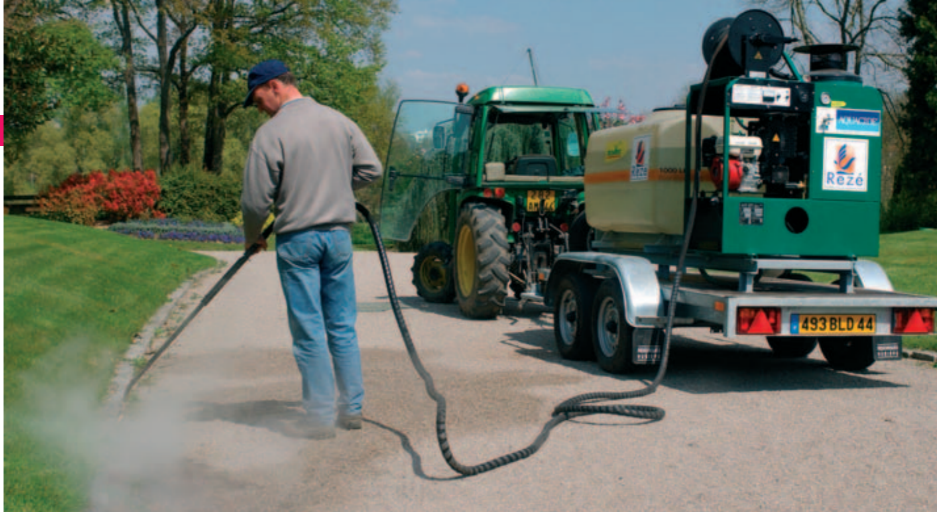
En substituant l'eau bouillante aux pesticides, l'aquacide permet de désherber sans polluer.
