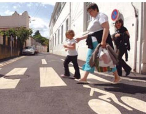
Fin des travaux réalisés par Nantes Métropole. Un plateau surélevé a été mis en place pour sécuriser les circulations piétonnes et ralentir les automobilistes. La chaussée a été rénovée. Intégrée à la zone 30 km/h de Saint-Paul, la voie est désormais bordée par une bande cyclable et une liaison piétonne le long du groupe scolaire Roger-Salengro. Coût de l'opération : près de 100 000 €.
